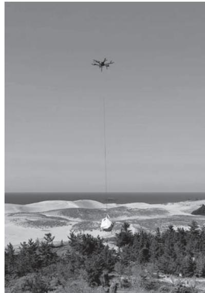
写真-2 漂着ゴミドローン運搬状況
