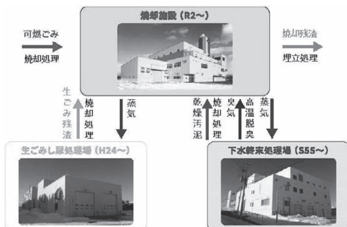
図-3 循環型ごみ処理システム
