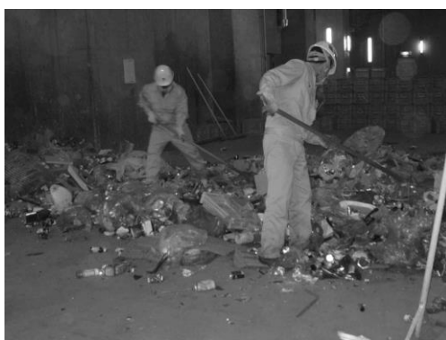
写真11 投入ステージ（手選別作業時）
