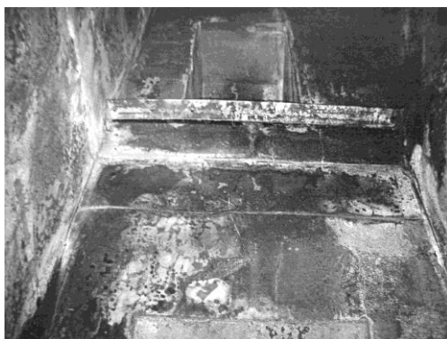
写真3、4 焼けただれたコンベア内部
