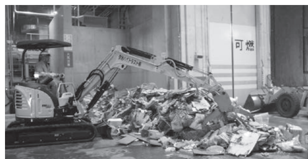
図-6 爪付バックホウによる異物除去
